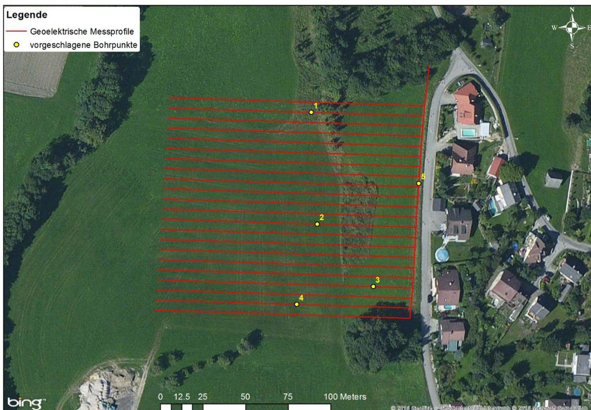
Abb. 2.2.4.1.: Lage der geoelektrischen Profile (Orthofoto bing) sowie die Positionen der vorgeschlagenen Bohrpunkte (Abbildung entnommen aus Jochum et al., 2016).
