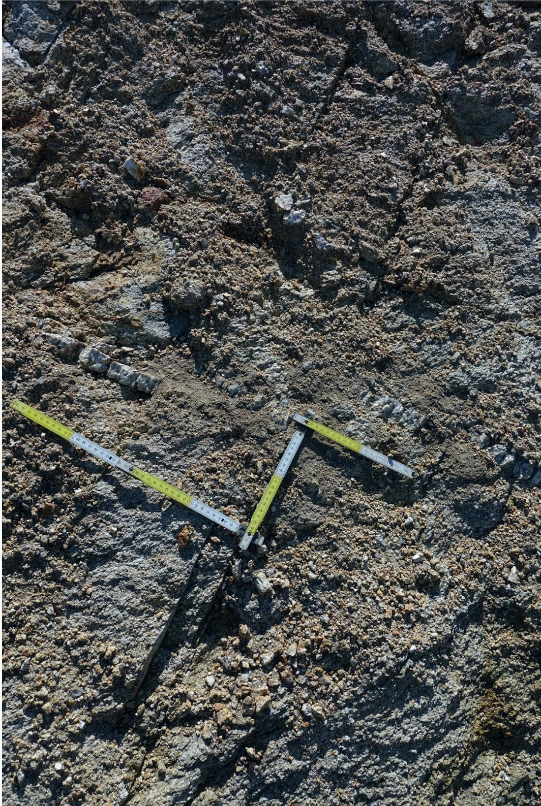
Abb. 2.1.1.15.: Hanganschnitt Baustelle Altenberg bei Linz: Die beiden Segmente des abgebildeten Masstabes zeigen die zwei Hauptkluftrichtungen (NNW/SSE und ENE/WSW) siehe auch Lagekugel (Foto: M. Peresson).
