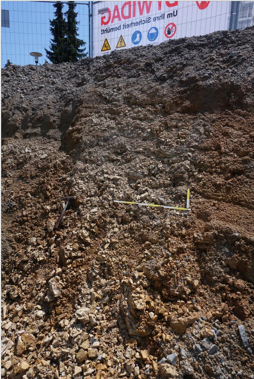
Abb. 2.1.2.14.: Business Campus ONE in Hagenberg: 80 cm breiter Aplitung bis an die Geländeoberkante mit einer Streichrichtung von  $136^\circ$  (Foto: M. Peresson).
