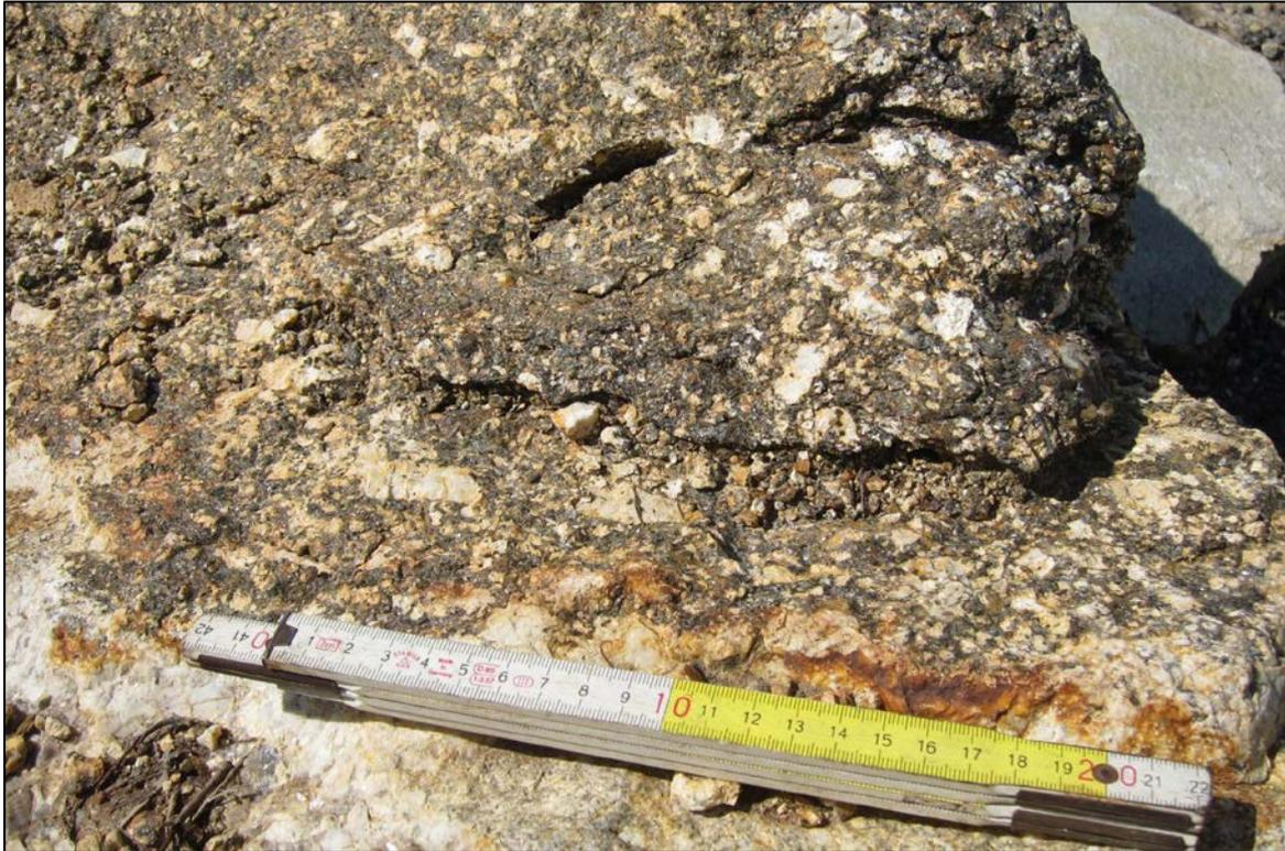
Abb. 2.1.1.20.: Hanganschnitt Baustelle Altenberg bei Linz: Im östlichen Teil des Bauplatzes konnte der Übergang von grobkörnigem Weinsberger Granit zu feinkörnigem Altenberger Granit beobachtet werden (Foto: M. Peresson).
