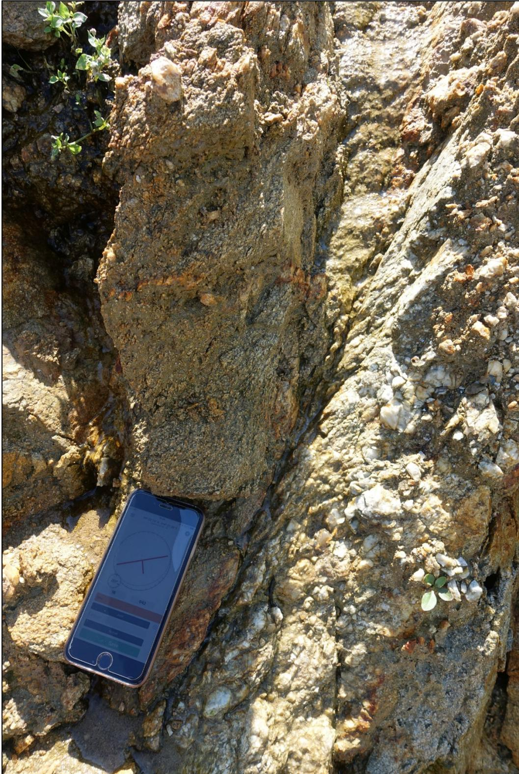
Abb. 2.1.1.19.: Hanganschnitt Baustelle Altenberg bei Linz: Deutlich ausgeprägte Kluftbildungen im Bereich der Scherzone (Foto: M. Peresson).
