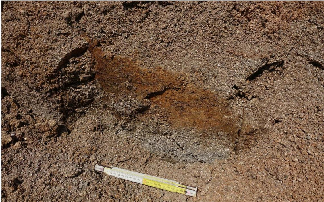
Abb. 2.1.2.10.: Business Campus ONE in Hagenberg: stark vergruster Freistädter Granodiorit in der Baugrube; Korngefüge weitgehend aufgelöst (Foto: M. Peresson).
