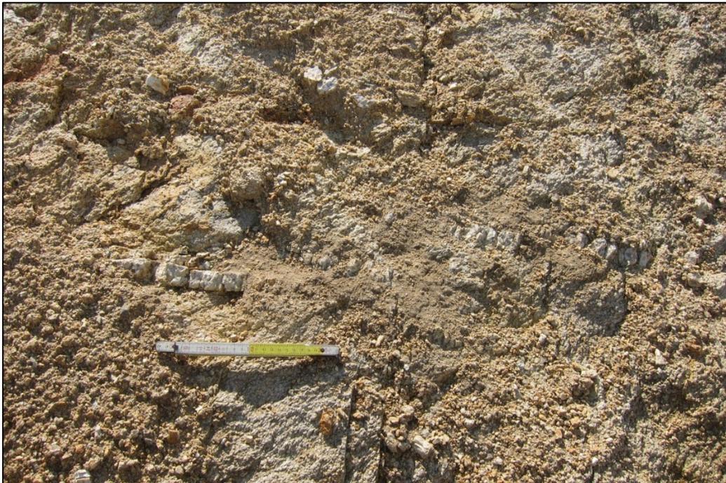
Abb. 2.1.1.14.: Hanganschnitt Baustelle Altenberg bei Linz: Geringmächtige Pegmatitgänge im stark verwitterten Altenberger Granit (Foto: M. Peresson).
