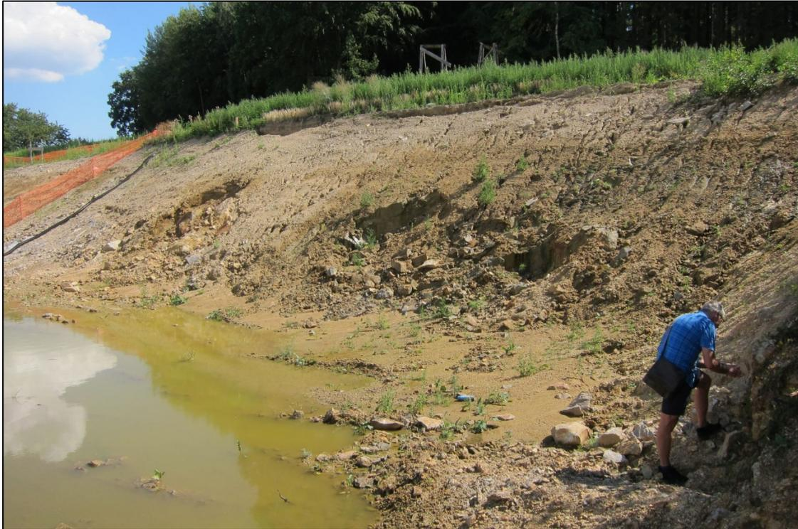
Abb. 2.1.1.16.: Hanganschnitt Baustelle Altenberg bei Linz: Außerhalb des unmittelbaren Baustellenbereiches im Ostteil des Geländes war relativ unverwitterter Altenberger Granit anzutreffen (Foto: M. Peresson).
