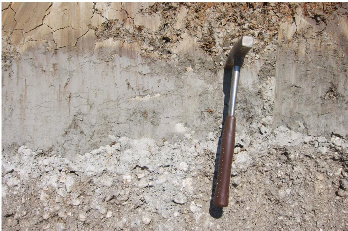
Abb. 2.3.1.15.: Detailaufnahme der Aufschlusswand in Baumgartenberg; Grenzbereich Kiese/hellgrauer Schluff/vergleyter Schluff (Foto: M. Peresson).
