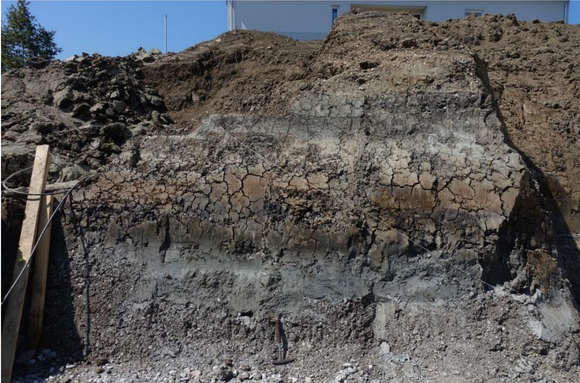
Abb. 2.3.1.11.: Detailaufnahme der Aufschlusswand in Baumgartenberg; an der Basis sandige graue Kiese, überlagert von hellgrauem Schluff/Ton und torfigen Sedimenten; am Top tritt rötlichbrauner Schluff auf (Foto: M. Peresson).
