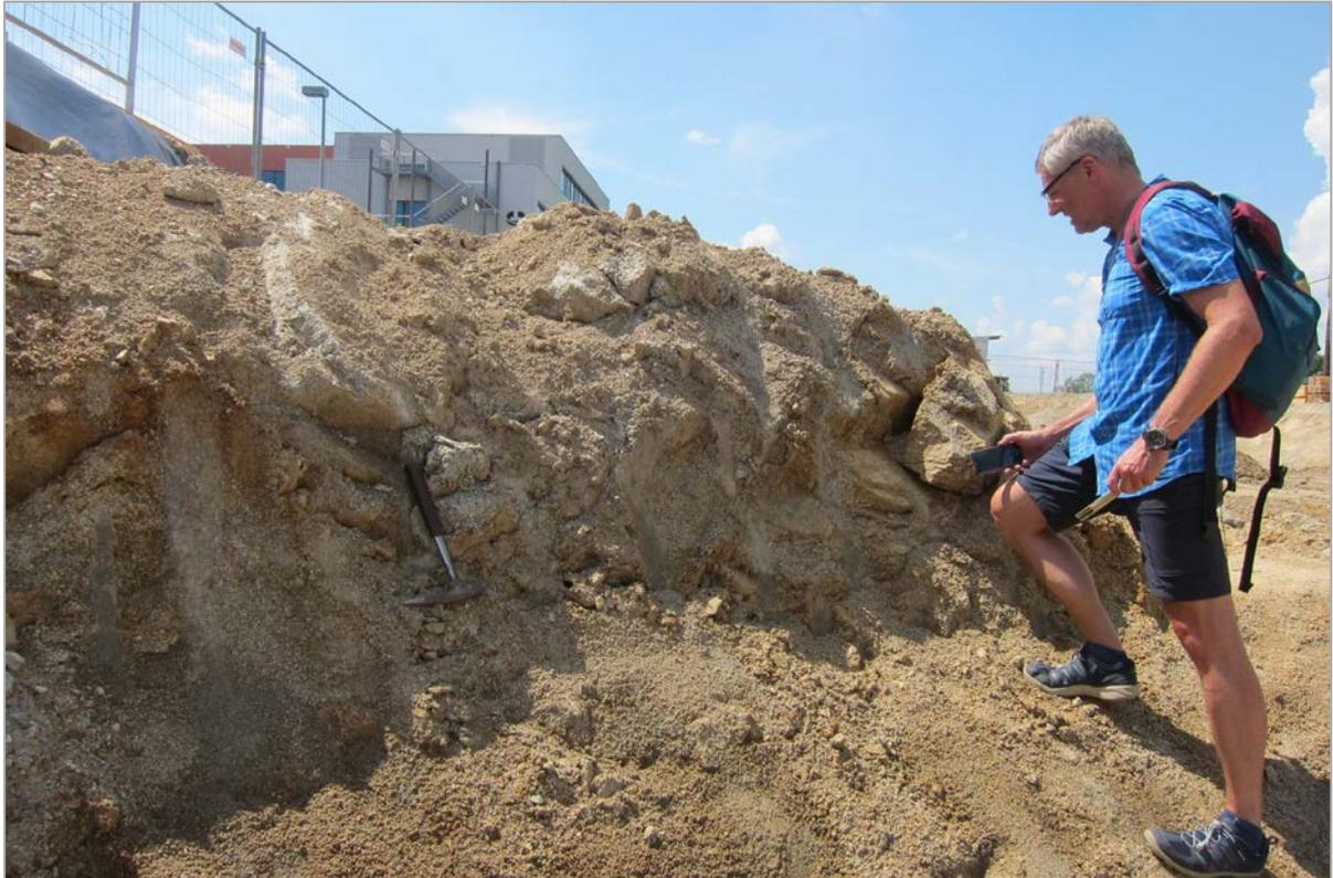
Abb. 2.1.2.22.: Business Campus ONE in Hagenberg: anstehender, gut geklüfteter Freistädter Granodiorit innerhalb einer NW-SE streichenden Störungszone parallel zum Pfahlstörungssystem (Foto: M. Peresson).
