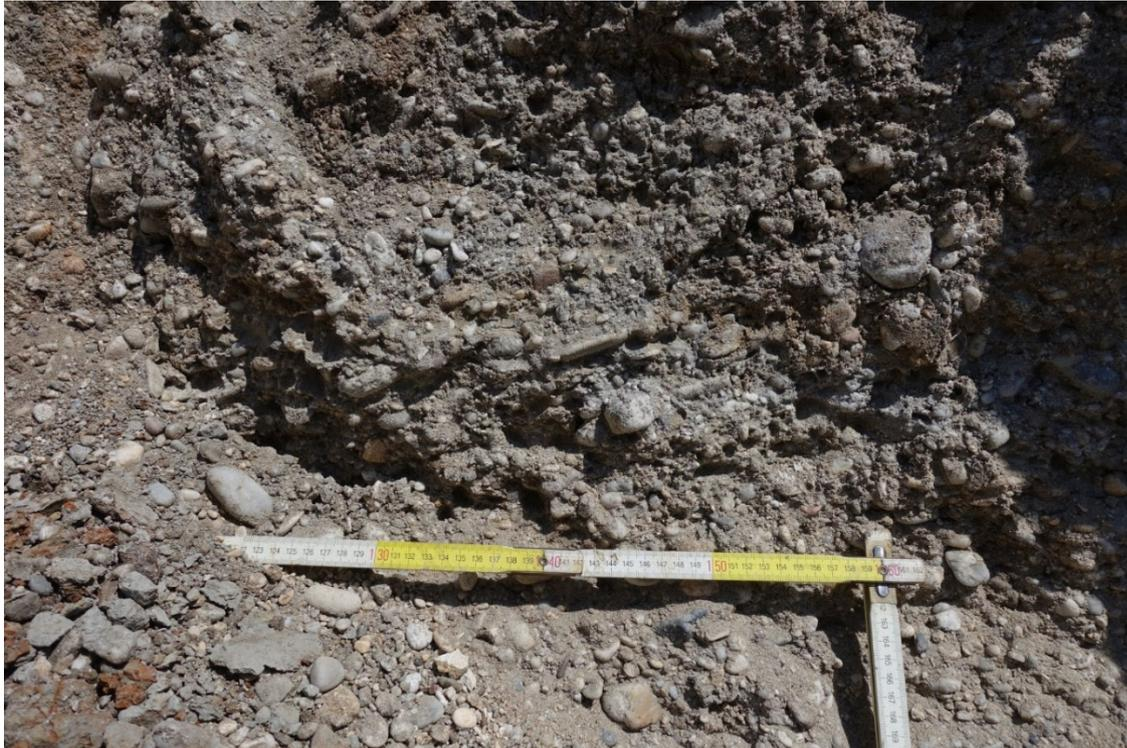
Abb. 2.3.1.17.: Detailaufnahme der Aufschlusswand in Baumgartenberg; eingeregelt Kiese Richtung Nordost (Foto: M. Peresson).
